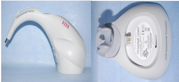
Şekil 2. Vita Easy Shade Compact dijital spektrofotometre.
