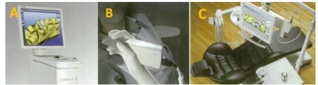
Şekil 1. CEREC 3 sistem. A. Görüntüleme ünitesi, B. Sisteme ait 3D kamera, C. Diş ünitesine entegre edilmiş CEREC 3 sistem ( http://www.dentistryforsandiego.com )
