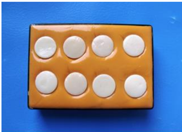
Resim 2. Örneklerin silikonda muhafaza edilmesi
