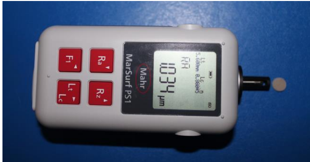
Resim 1. Profilometre cihazı ve kullanılan bir numune
